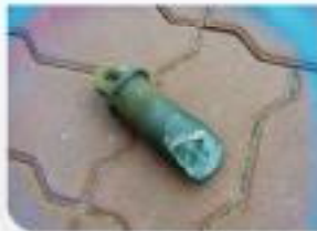
사물핀 균열 파손
